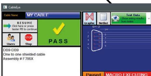
Der Produktionsbildschirm ermöglicht dem Bediener einfach den Prüfabläufen zu folgen und dabei Probleme mit der Verkabelung leicht zu erkennen. Je nach Benutzer können auch die Abläufe und freigegebenen Funktionen variiert werden.
