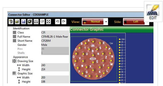
Benutzen Sie die PinMap-Software, um kundenspezifische Prüfvorrichtungen, kundenspezifische CB-Platinen, speziell angefertigte Anschlussfelder oder Pigtail-Adapter mit dem CableEye-System zu verbinden. Über die mitgelieferte Tastspitze geschieht das einlernen der sogenannten „Maps“ ganz automatisch.
