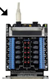
Das CB35 Relay Board ermöglicht die Verschaltung von externen Geräten zur vollständigen Steuerung und Automatisierung Ihrer Prüfstation. Es bietet 10 Relaisausgänge und kann so oft wie nötig kaskadiert werden.
